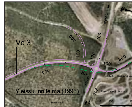
Kuva 16. VE 3 Kiertoliittymä nykyisen liittymän paikalla
